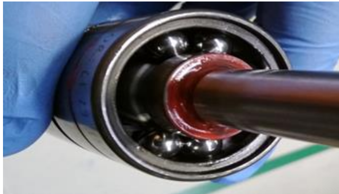
Figura 14.5 PokaYokede falta de jaula de rodillos
