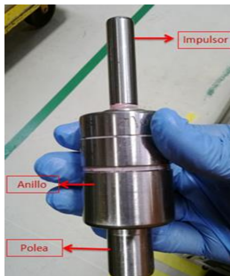
Figura 14.9 PokaYoke de diámetros exteriores bajo tolerancias
