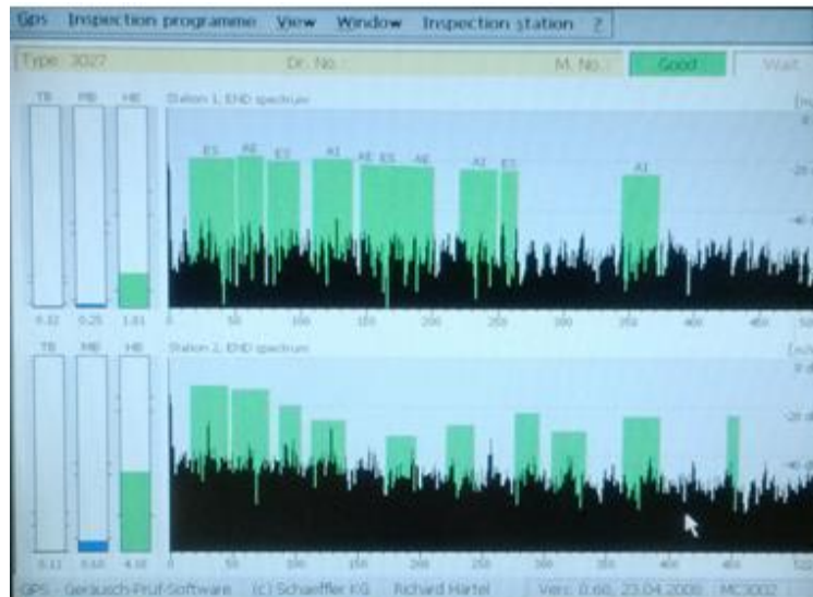
Figura 14.2 PokaYoke de ruido de anillo sin honear
